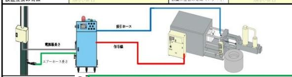
⑦ 工場エア圧 数値 MPa (必要圧力：0.5MPa、必要流量：150L/min)
